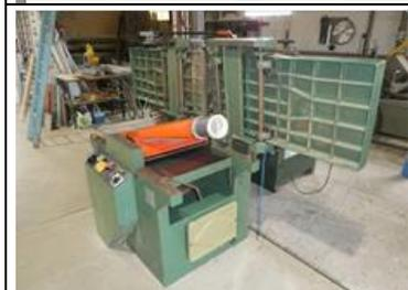
dégauchisseuse raboteuse de marque STETON modèle
